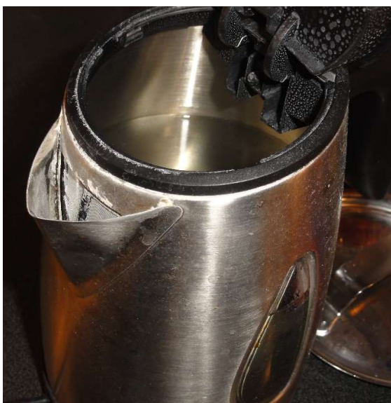
Figur 4-6. Avlagringar på en vattenkokare.
